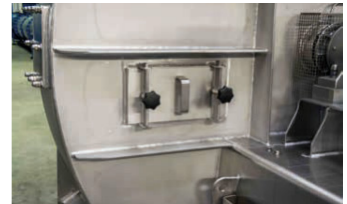
Inspektionsöffnung mit Schnellverschlüssen
