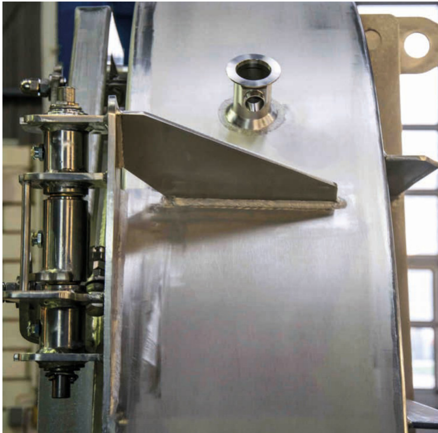
Reinigungsstutzen zum Einlassen von Reinigungsflüssigkeit
