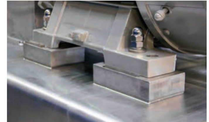
Hohe Unterlage zur leichteren Reinigung
